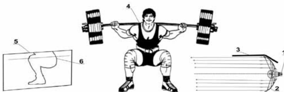
Рис. 1. Схема дії пристрою дистанційного контролю кута нахилу стегна відносно гомілки: 1 – освітлювач, 2 – параболічний рефлектор, 3 – захисна шторка, 4 – спортсмен, 5 – екран, 6 – тіньовий контур стегна і гомілки.
