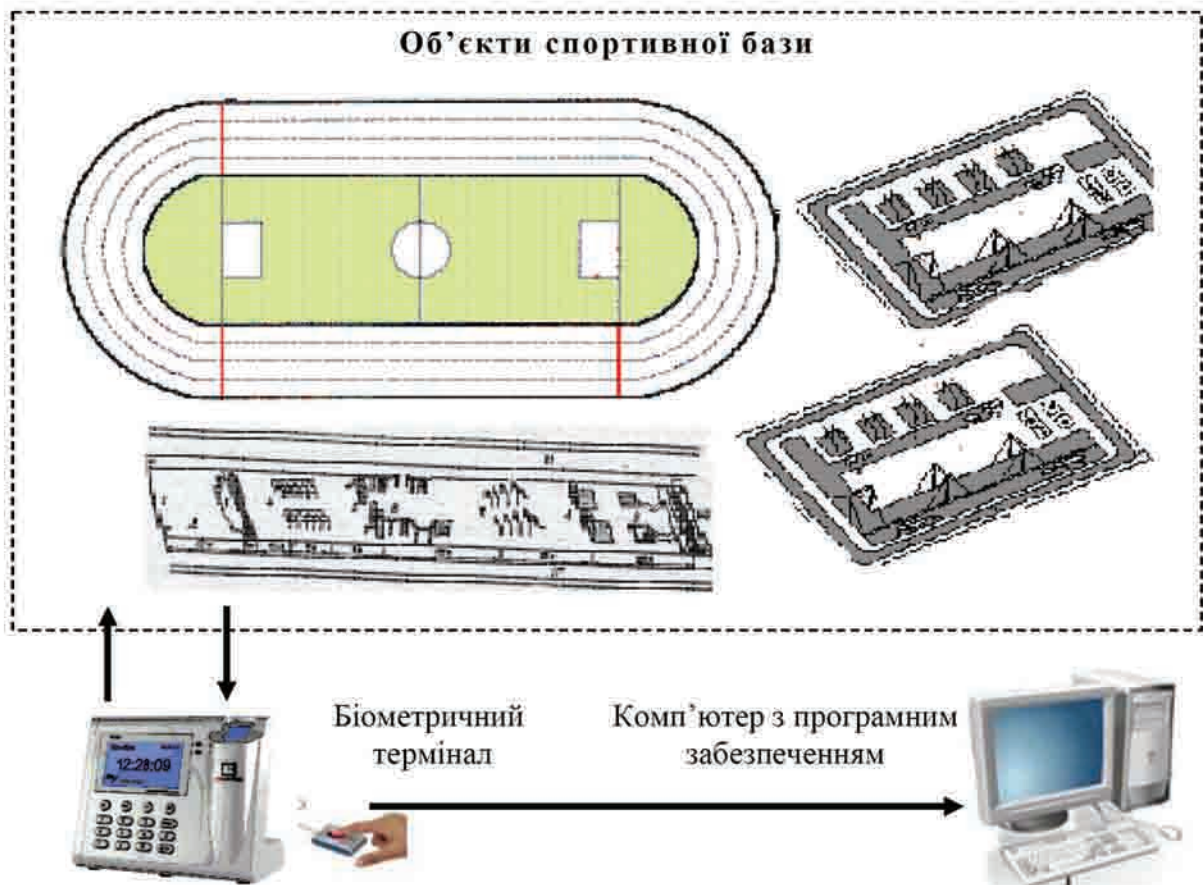
Рис. 1 Технологічна схема роботи біометричного терміналу обліку часу тренування
